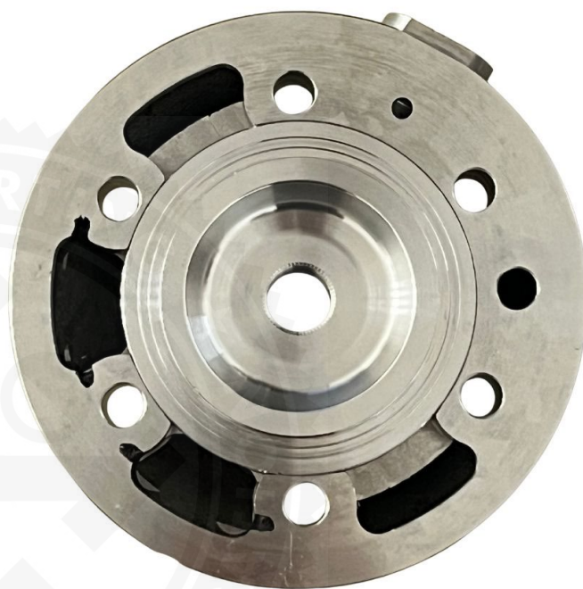
Photo de la culasse et de la chambre de combustion / Photo of the cylinder head and combustion chamber
